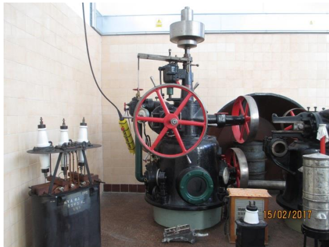
Stuletni regulator obrotów z elektrowni wodnej
